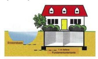
Falsche Bauausführung kann zu Erosion und somit zur Unterspülung der Fundamente führen. Durch den Austrag von Bodenteilchen aus dem Bodengefüge kann es zu Hohlräumen im Baugrund kommen, die Gebäudeschäden infolge von Setzungen verursachen.
