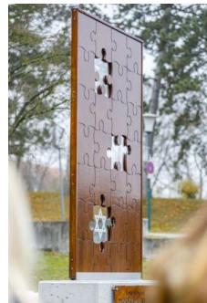
Das Mahnmal besteht aus zwei zusammengesetzten Stahlplatten mit zwischengelagertem Glas. Die Stahlplatten sind in einem Betonsockel befestigt. Aus den Stahlplatten sind Puzzleteile gefräst, im unteren fehlenden Puzzlestein ist auf das Glas ein Davidstern geklebt.
